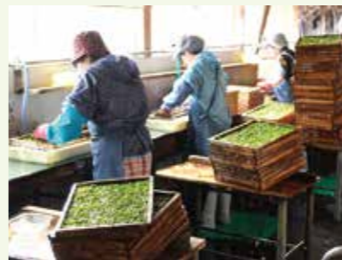
刻んだコンブをセイロに均一に敷き詰める。角にもきっちり敷き、ムラが出来ないようにする。
