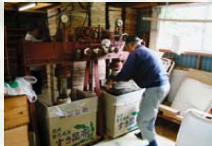
箱詰めのため機械で昆布を圧縮する作業。1箱に200枚入る（13時25分）
