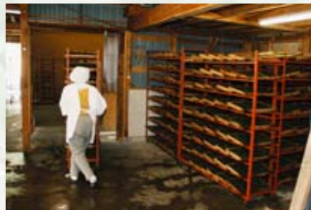
板状にすいた昆布を乾燥場に入れる。1回約700枚。60度・7時間乾燥させる（13時20分）
