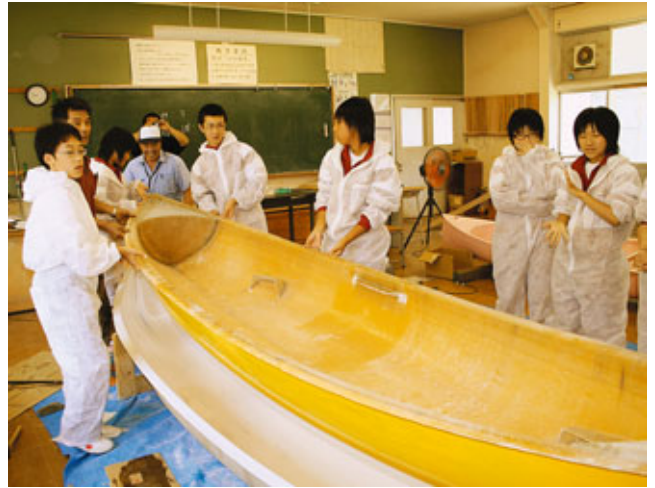
型枠から黄色い船体が現れた長さ4mの自作カヌー
